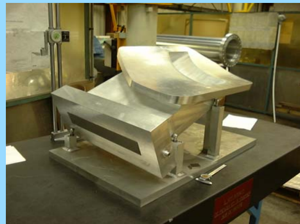
Mechanisches bearbeiten der Stutzen
