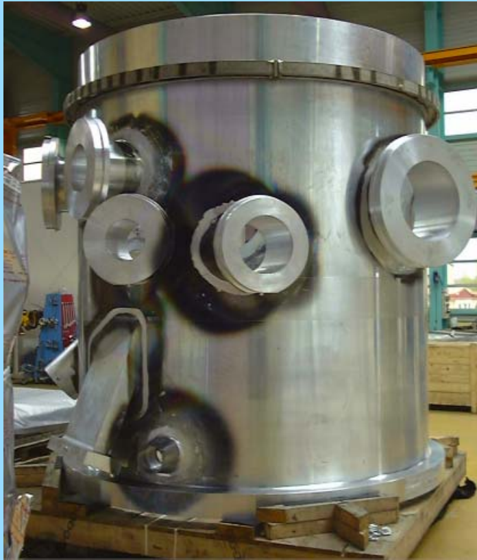
Nach dem EB-Schweißen der Mantelstützen
