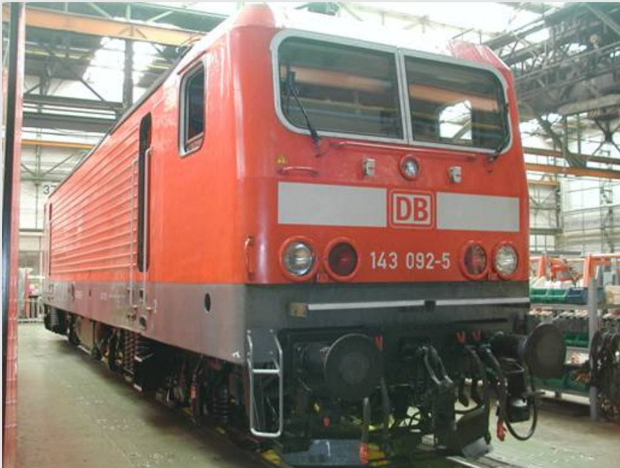
Lokomotive der Baureihe 143 mit jeweils 4 Radsätzen
